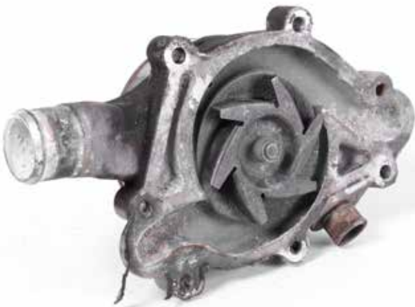
Mal estado del sistema de enfriamiento (Cavitación)
