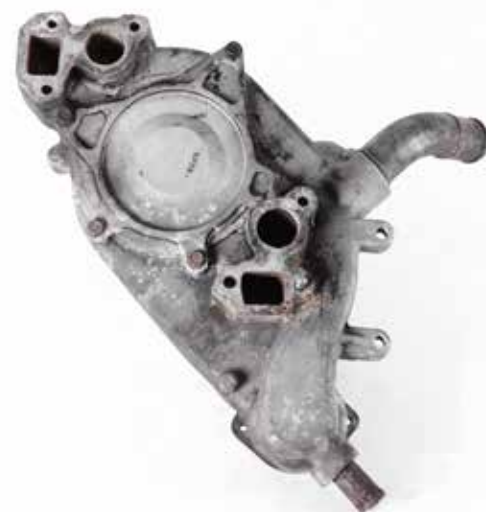
● Mantenimiento deficiente de AC/ F+W
