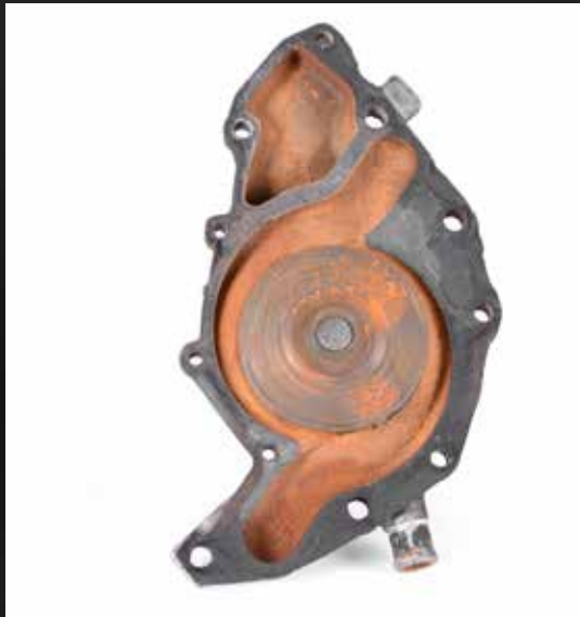
Problemas del Sistema de Enfriamiento: Contaminación Reflérase a Páginas 16-17
