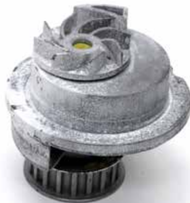
Condición deficiente del sistema de enfriamiento (Electrólisis)
